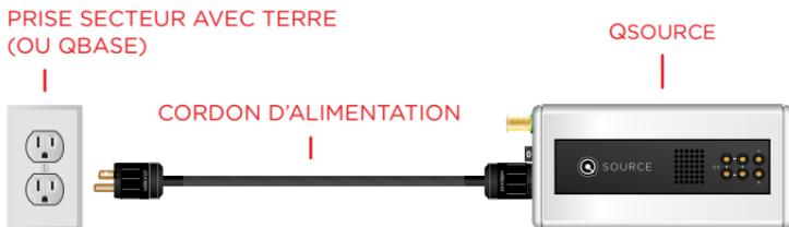
Une fois la bonne tension sélectionnée et l'appareil branché, vous pouvez mettre le module QSOURCE sous tension à l'aide de l'interrupteur situé à l'extrémité de l'unité, entre la borne de mise à la terre et la prise du cordon d'alimentation. **Veillez cependant à ce que le module soit hors tension lorsque vous y connectez des appareils ou que vous modifiez la tension.** Une LED bleue reste allumée à l'autre extrémité du module QSOURCE lorsqu'il est sous tension.
